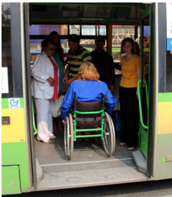
Рисунок 1.15.2.2 – Отсутствие площадки для представителя МГН в подвижном составе
