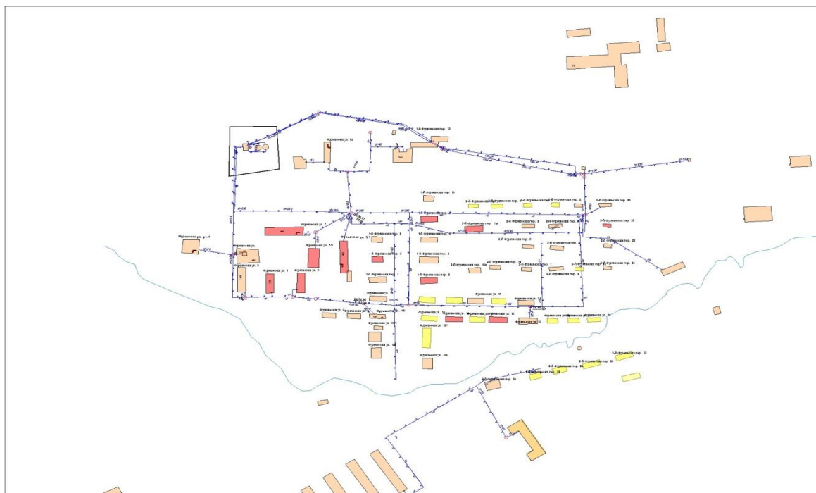
Рисунок 20 - Зона водоснабжения водозабора Чапаевка
