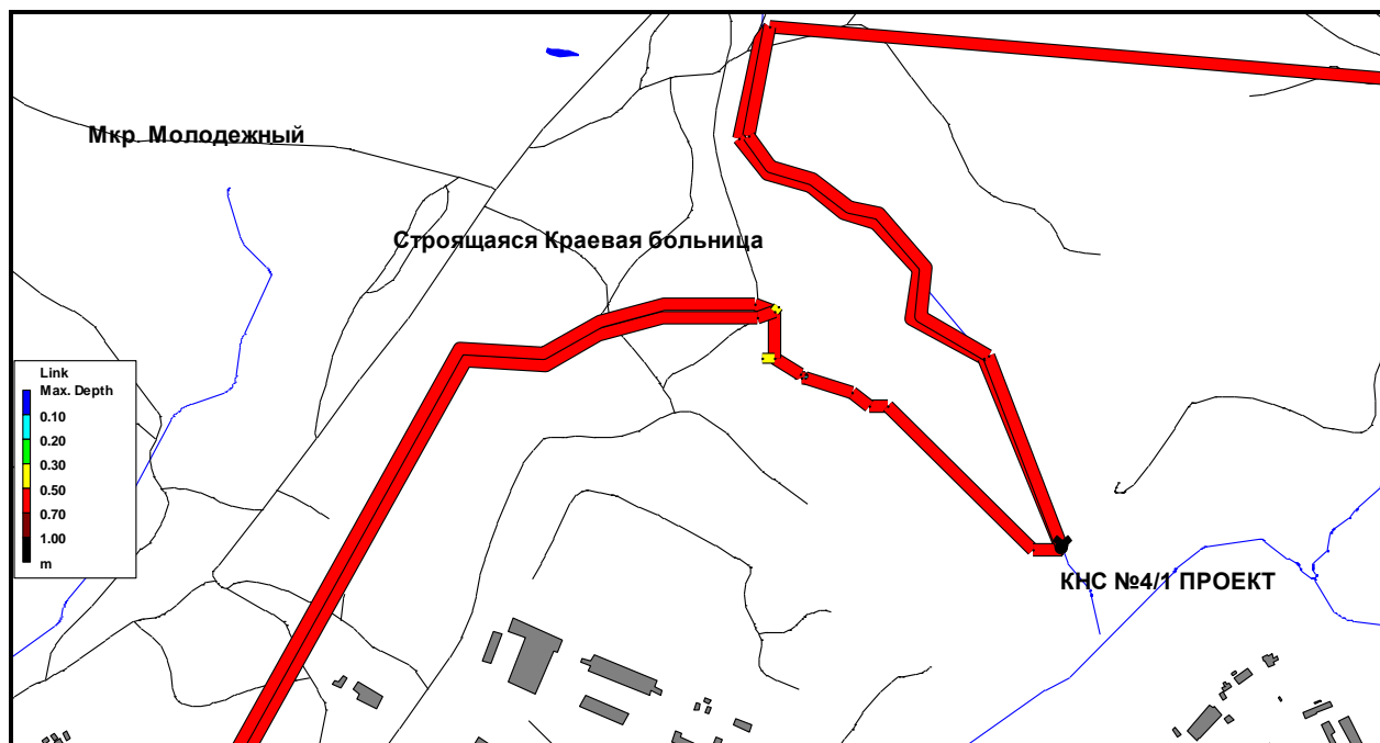
Рисунок 54 - Гидравлическая модель самотечного коллектора от территорий поселка Молодежный с краевой больницей до проектируемой КНС №4/1
